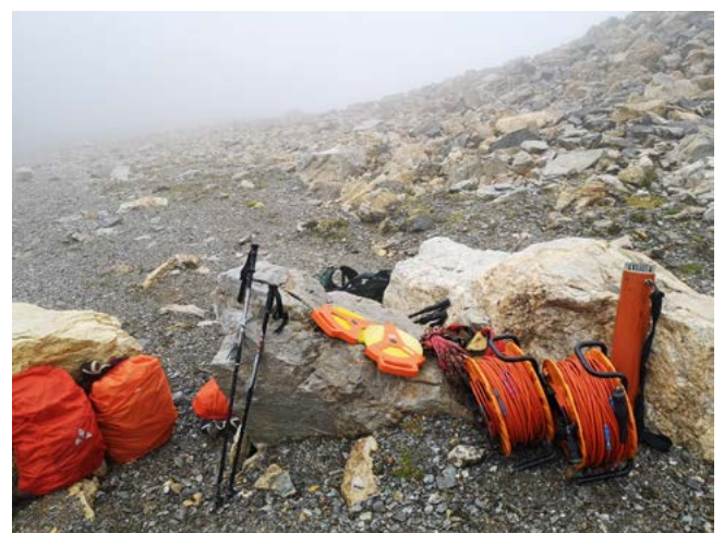
Ausrüstung für die ERT-Messungen auf dem Blockgletscher.
